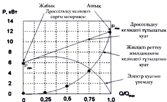
1.5 Сурет – Сорғыдағы су шығынының қатынасына электр қозғалтқыш қуатының тәуелділік графиктері.
